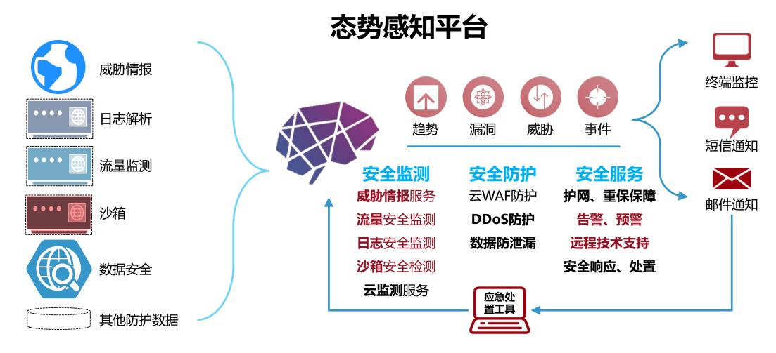
应对网络安全风险最主要的是做好安全运营,即在安全防护的基础上,进行全方位的安全监测,从监测结果发现问题,进行处置。通过威胁情报、日志审计、流量监测、应用层防护、主机端防护等防护手段进行防护,将防护数据统一送到安全威胁检测响应平台,进行关联分析,将结果进行呈现,将安全事件进行告警,并提供快速处置功能。
